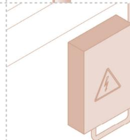
Для воздушной прокладки электричества предусмотрен анкерный болт для крепления кабеля на расстоянии от земли не менее 2750 мм.
