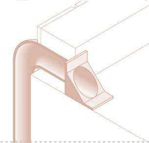
Киоск оборудован системой водоотведения. Предусмотрена парапетная воронка с горизонтальным выпуском для отведения дождевых вод в наружный водосток. Кровля оснащена гидроизоляционным слоем. Уклон кровли 3-5%.
