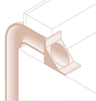
Туалет оборудован системой водоотведения. Предусмотрена парашютная воронка с горизонтальным выпуском для отведения дождевых вод в наружный водосток. Кровля оснащена гидроизоляционным слоем. Уклон кровли 3-5%.
