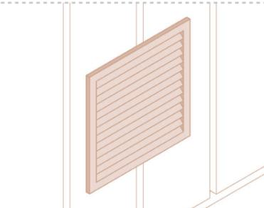
Туалет оборудован системой вентиляции, для которой предусмотрено устройство вытяжной решетки, выполненной в едином колористическом решении с фасадом объекта. Высота установки не менее 2400 мм от уровня земли, габариты решетки не более 200x200 мм.
