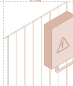
Для воздушной прокладки электричества предусмотрен анкерный болт для крепления кабеля на расстоянии от земли не менее 2750 мм.
