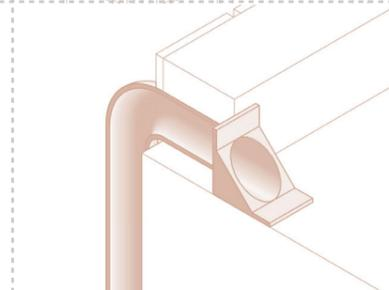
Киоск оборудован системой водоотведения. Предусмотрена парапетная воронка с горизонтальным выпуском для отведения дождевых вод в наружный водосток. Кровля оснащена гидроизоляционным слоем. Уклон кровли 3-5%.
