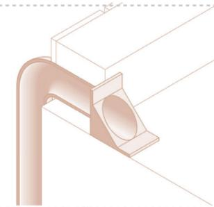
Павильон оборудован системой водоотведения. Предусмотрена парпетная воронка с горизонтальным выпуском для отведения дождевых вод в наружный водосток. Кровля оснащена гидроизоляционным слоем. Уклон кровли 3-5%.
