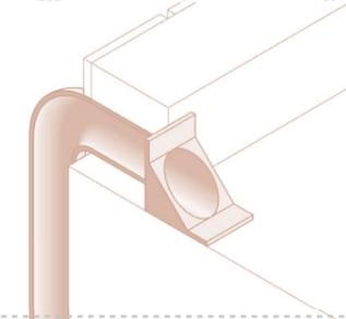
Киоск оборудован системой водоотведения. Предусмотрена парапетная воронка с горизонтальным выпуском для отведения дождевых вод в наружный водосток. Кровля оснащена гидроизоляционным слоем. Уклон кровли 3-5%.
