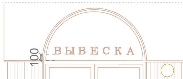
Вывеска размещена на расстоянии 200 мм от нижней отметки парапета; Выравнивается относительно центральной оси торгового фронта. Длина вывески не более 2000 мм
