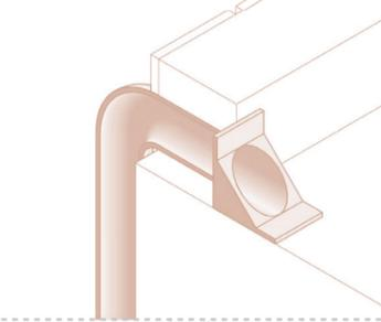
Павильон оборудован системой водоотведения. Предусмотрена парапетная воронка с горизонтальным выпуском для отведения дождевых вод в наружный водосток. Кровля оснащена гидроизоляционным слоем. Уклон кровли 3-5%.
