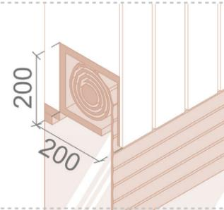
Для роллетной системы монтируется скрытый монтаж короба. Цвет роллетного полотна – RAL 9011. Цвет рамы остекления — RAL 9011.
