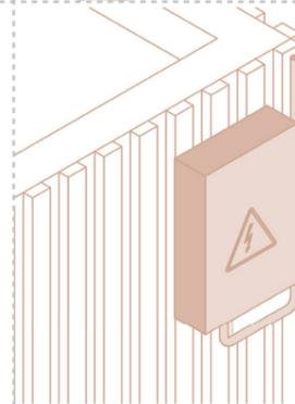
Для воздушной прокладки электричества предусмотрен анкерный болт для крепления кабеля на расстоянии от земли не менее 2750 мм.
