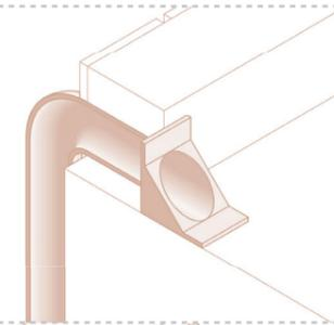
Туалет оборудован системой водоотведения. Предусмотрена парапетная воронка с горизонтальным выпуском для отведения дождевых вод в наружный водосток. Кровля оснащена гидроизоляционным слоем. Уклон кровли 3-5%.
