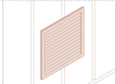
Туалет оборудован системой вентиляции, для которой предусмотрено устройство вытяжной решетки, выполненной в едином колористическом решении с фасадом объекта. Высота установки не менее 2400 мм от уровня земли, габариты решетки не более 200x200 мм.
