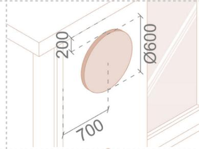
В качестве подложки для логотипа использован "световой короб" диаметром 800 мм. световой короб расположен на высоте 1420 мм от уровня земли.
