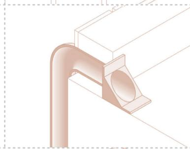
Туалет оборудован системой водоотведения. Предусмотрена парапетная воронка с горизонтальным выпуском для отведения дождевых вод в наружный водосток. Кровля оснащена гидроизоляционным слоем. Уклон кровли 3-5%.
