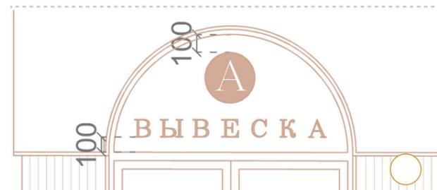
Логотип размещен на расстоянии не менее 100 мм от нижней отметки парапета; Выравнивается относительно левой части торгового фронта
