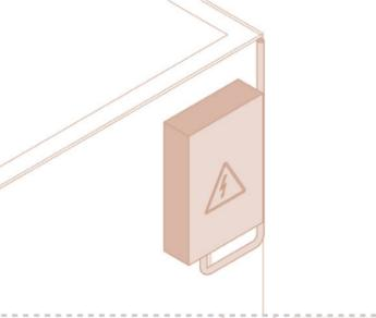
Для воздушной прокладки электричества предусмотрен анкерный болт для крепления кабеля на расстоянии от земли не менее 2750 мм.
