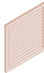
Туалет оборудован системой вентиляции, для которой предусмотрено устройство вытяжной решетки, выполненной в едином колористическом решении с фасадом объекта. Высота установки не менее 2400 мм от уровня земли, габариты решетки не более 200x200 мм.
