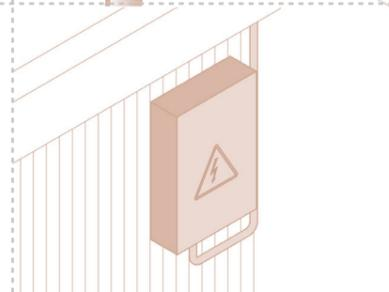
Для воздушной прокладки электричества предусмотрен анкерный болт для крепления кабеля на расстоянии от земли не менее 2750 мм.
