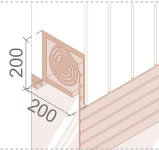
Для роллетной системы монтируется скрытый монтаж коробка. Цвет роллетного полотна – RAL 9011. Цвет рамы остекления — RAL 9011.
