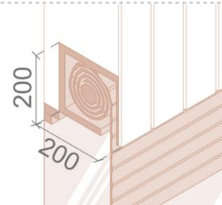
Для роллетной системы монтируется скрытый монтаж короба. Цвет роллетного полотна – RAL 9011. Цвет рамы остекления — RAL 9011.
