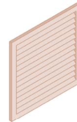
Туалет оборудован системой вентиляции, для которой предусмотрено устройство вытяжной решетки, выполненной в едином колористическом решении с фасадом объекта. Высота установки не менее 2400 мм от уровня земли, габариты решетки не более 200x200 мм.
