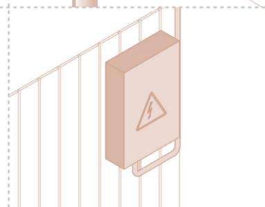
Для воздушной прокладки электричества предусмотрен анкерный болт для крепления кабеля на расстоянии от земли не менее 2750 мм.
