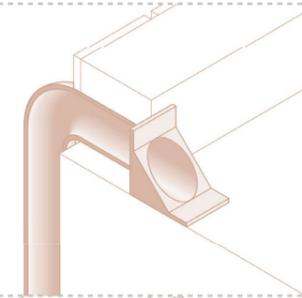
Туалет оборудован системой водоотведения. Предусмотрена парапетная воронка с горизонтальным выпуском для отведения дождевых вод в наружный водосток. Кровля оснащена гидроизоляционным слоем. Уклон кровли 3-5%.
